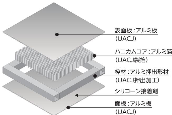
当社のハニカムパネルは、CO<sub>2</sub>排出の少ない接着方法を採用し、リサイクルによる省エネルギー化と合わせ、カーボンニュートラルに貢献できます。アルミニウム総合メーカーのUACJグループとの連携により使用後のハニカムパネルのリサイクル技術を確認しています。
