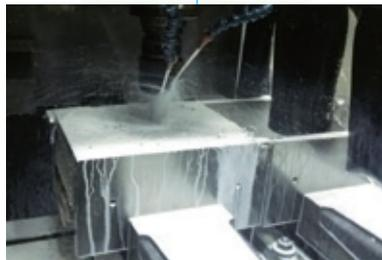
旋盤・マシニングセンターなどの工作機械を用い、ドリルなどの機械工具で仕上げる切削加工です。
